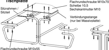
Verbindungsstange (nur bei Massivplatte)
